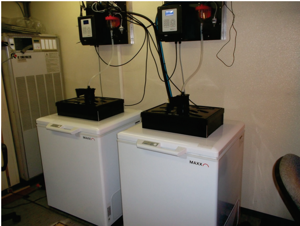
Abbildung 4: Probenahmegeräte mit sofortiger Tiefkühlung im Messcontainer (Foto: LAU)
