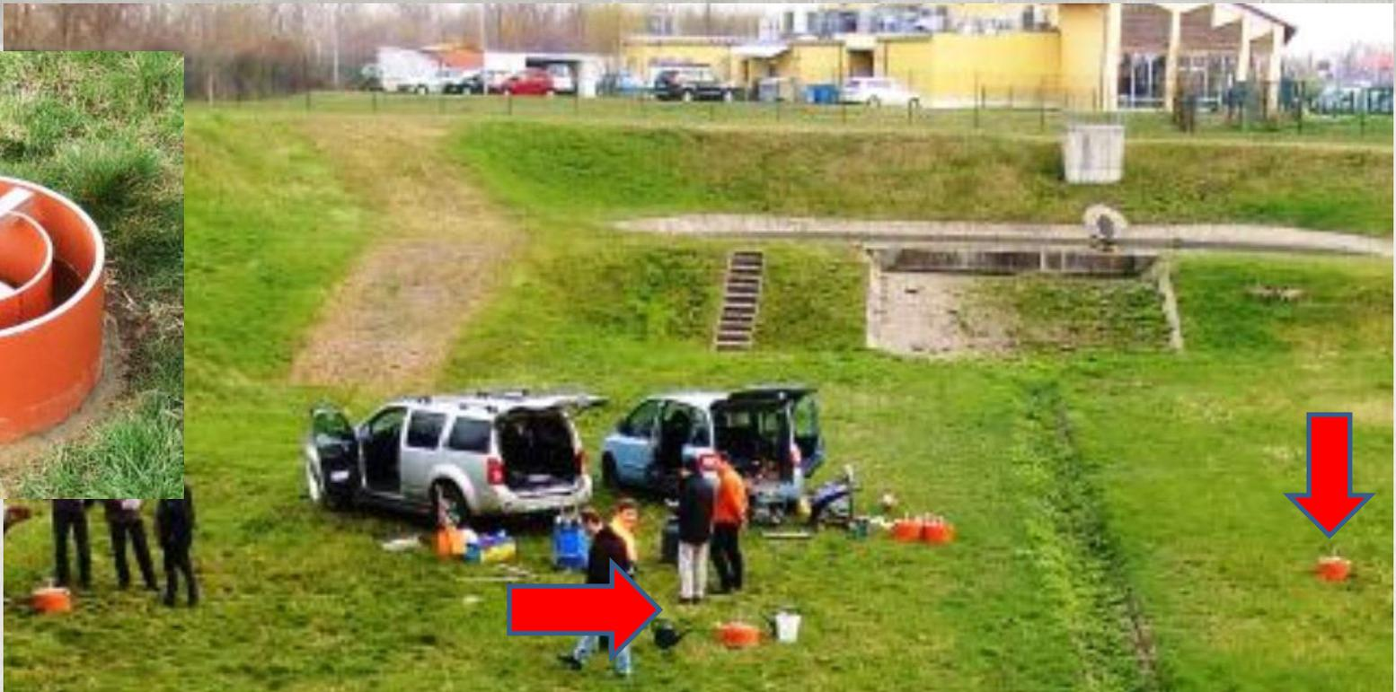
Ergebnis: Sickerraten der 30 cm Mutterbodenauflage (tonig)
