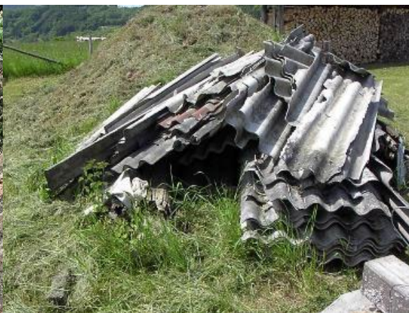
Foto 12: Asbestplatten; Quelle: Abfallberatung, Lk Main-Spessart/ abfallbild.de
