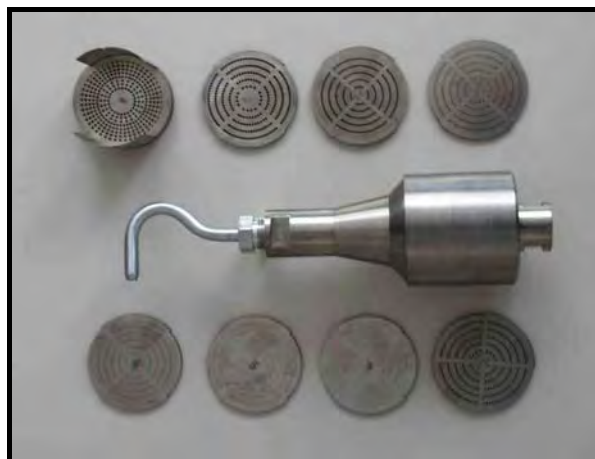
Abbildung 8: 6-stufiger Impaktor Typ STF 1
