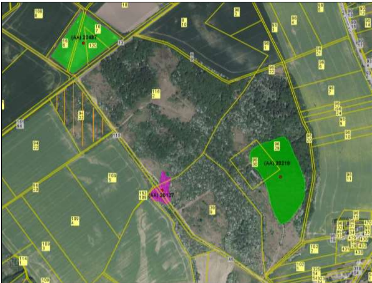
Abb. 11: Altlastenverdachtsflächen (ALVF) im PG: AA 20127 Mülldeponie Blonsberg; AA 20219 militärische ALVF sowie eine ehemalige Lagerfläche für Erntegut (nicht als ALVF erfasst; orange schraffiert) (schriftl. Mitt. LK Saalekreis, Untere Bodenschutzbehörde).
