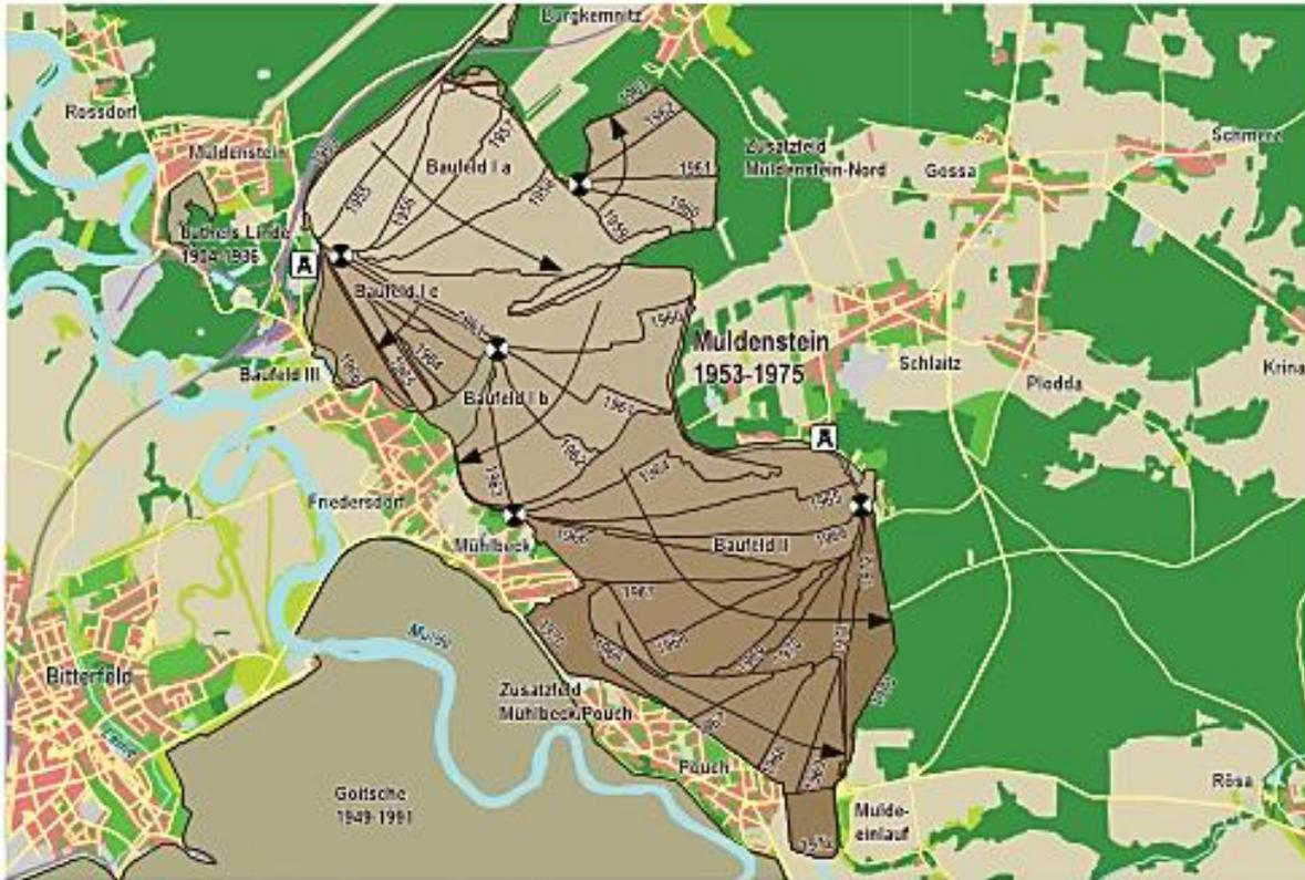
Abb. 3.3: Tagebau Muldenstein – Lage und Abbauprozess (Quelle: LMBV 2017).
