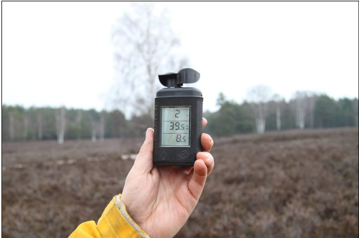
Abb. 20 Witterungsparameter am Tag des Feuereinsatzes (von oben nach unten: Windgeschwindigkeit [m/s], relative Luftfeuchte [%], Temperatur [ C])
