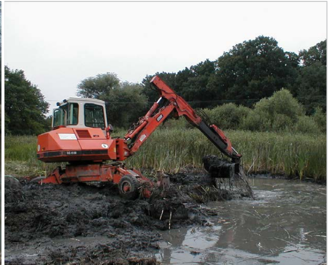
Abb. 14: Pflegemaßnahme zur Entschlammung eines Laichgewässers mit Vorkommen der Rotbauchunke bei Kleindröben (Foto: B. SIMON).
