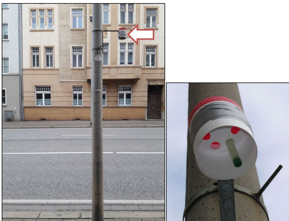
Abbildung 4: Passivsammler Halberstadt/Friedenstraße, rechts Detailaufnahme Wetter- schutzgehäuse mit Sammlerröhrchen
