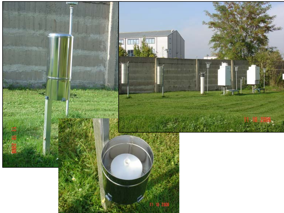
Abbildung 2.4.12: Niederschlagsmesser nach Hellmann (Standort Halle Ost)
