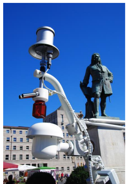
Bild 4: Messtechnik des Profilmesswagens des DWD zur Erfassung der Lufttemperatur und Luftfeuchte in 2 m Höhe während der Messfahrt Bildrechte: LAU
