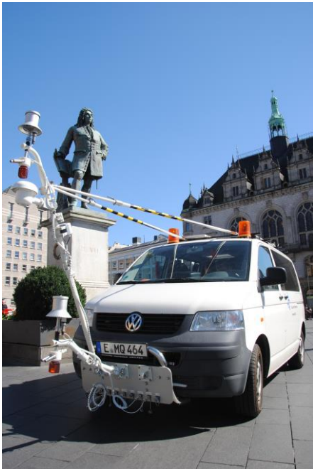
Bild 1 - 3: Der mit Messtechnik ausgestattete Profilmesswagen des DWD auf dem Marktplatz Bildrechte: LAU
