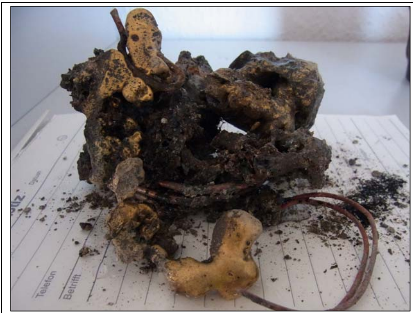
Abbildung 3: Unverbrannte Metalle und angeschmolzene Messingteile in einer EBS-Schlacke
